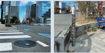
マンホールアンテナ(左)とスマート浸水標尺(右)
