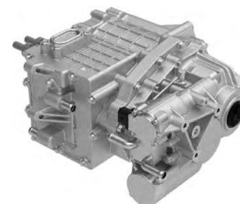
超小型e-Axleコンセプトモデル
