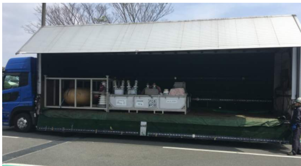
微量 PCB 廃棄物の搬出風景
