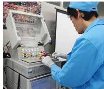
半導体デバイス電気特性評価 (パワーデバイスアナライザ)
