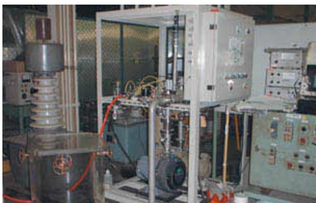
当社では、製品の絶縁ガスとして使用しているSF<sub>6</sub>の、大気への放出を抑制しています。本装置は、SF<sub>6</sub>ガス用モールド形計器用変成器・ブッシング・スペーサなどの耐圧試験装置ですが、試験に使用されるSF<sub>6</sub>ガスを、自動的に充填・回収して繰り返し使用出来るよう改善しました。
