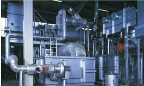
乾留形熱分解処理システム
