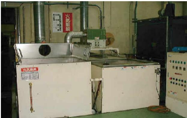
脱塩素系有機洗浄剤の取り組みで、炭化水素系洗浄剤に切り換えを行っています。本装置は、浸漬洗浄槽と熱風乾燥炉にて構成され、浸漬洗浄槽は、炭化水素系洗浄剤を熱媒体油にて間接加熱し、液攪拌を行いながら部材の洗浄を行います。その後、部材を熱風乾燥炉に移動し、強制乾燥させます。
