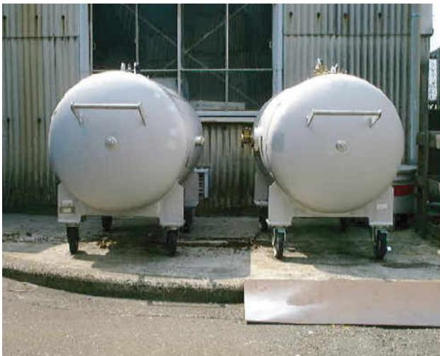
当社では、製品の絶縁ガスとして使用しているSF6の、大気への放出を抑制しています。そのため、機器の更新の際に、お客様の設備中のガスを回収しています。また、社内で使用しているSF6で劣化の少ないものはリユースし、ガス購入量の低減につなげています。さらに一部の使用済みガスは、社外の分解処分業者に委託処理しています。
