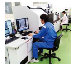
三次元X線CT装置による内部構造欠陥検査
