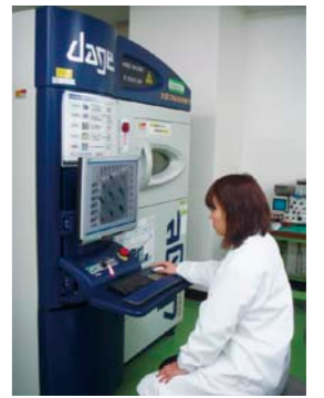
軟X線による電子部品の良品解析
