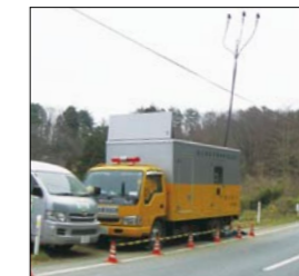
東北電力(株)様高圧応急電源車
