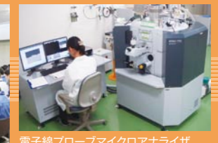
電子線プローブマイクロアナライザ（EPMA）による材料評価
