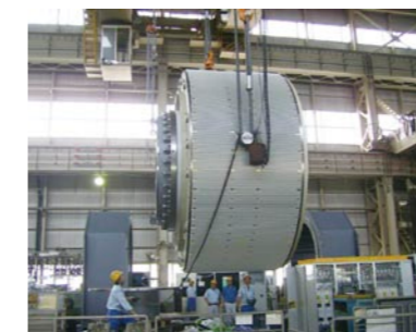
風力発電用発電機
