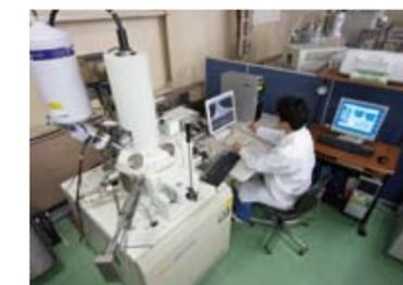
電子顕微鏡による部品評価
