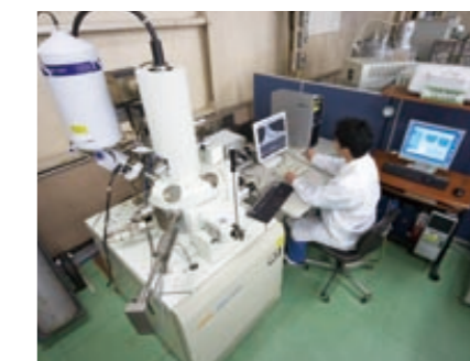
電子顕微鏡による部品評価
