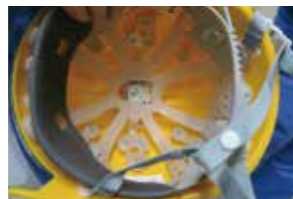
作業者のヘルメットの中にIDタグ
